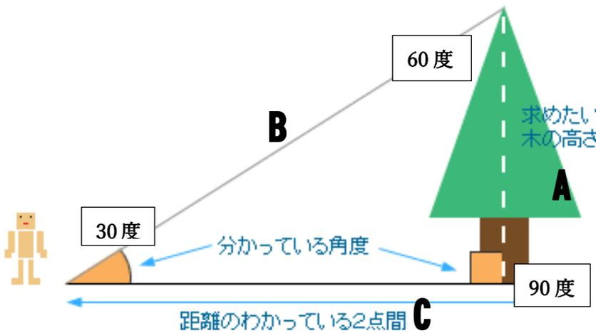
例えば、角の大きさが90度、60度、30度の直角三角形(三角定規の細長い方)で考えることにしましょう。この形の直角三角形なら、どんな大きさでもAとBとCの辺の長さには、1:2:1.73という長さの割合になっています。つまり、Aが10メートルだとしたら、Bは20メートル、CはAの1.73倍の長さで17.3メートルとなります。ちょうど30度の角度にスギのてっぺんが見えるところまで離れて、スギまでの距離(C)を測ったら、その長さを使ってスギの高さ(A)を求めることができるということです。
